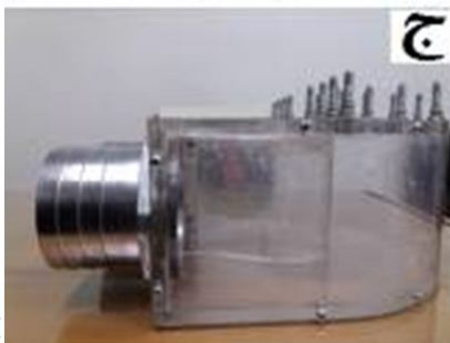
شکل ۲- الف) سیستم آزمایشگاهی شماره ۱ جهت تعیین توزیع عرضی فشار، ب) نمای تحتانی محفظه مکش هیدرولیکی و نمایش پارامترهای موقعیت مکانی نقاط اندازه‌گیری فشار، ج) نمای جانبی محفظه مکش هیدرولیکی
