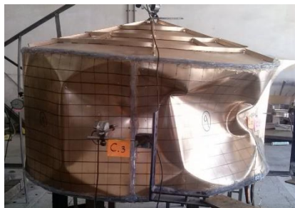
شکل ۱۴- فروریختگی مخزن ۳ در محل LVDT3
