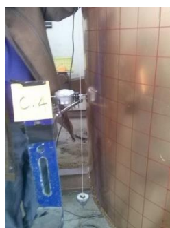
شکل ۶- اندازه‌گیری مقدار ناکاملی در نمونه‌های آزمایشگاهی
