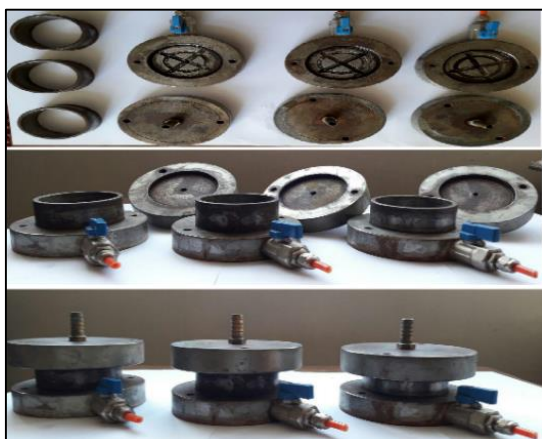
شکل ۲- قالب‌های قرارگیری نمونه‌های خاک برای تزریق محلول سمانتاسیون
