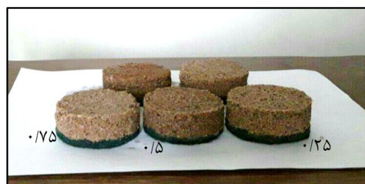
شکل ۶- نمونه‌های بهسازی شده خاک ماسه‌ای سست با غلظت‌های متفاوت (۰/۲۵، ۰/۵ و ۰/۷۵) mol/L
