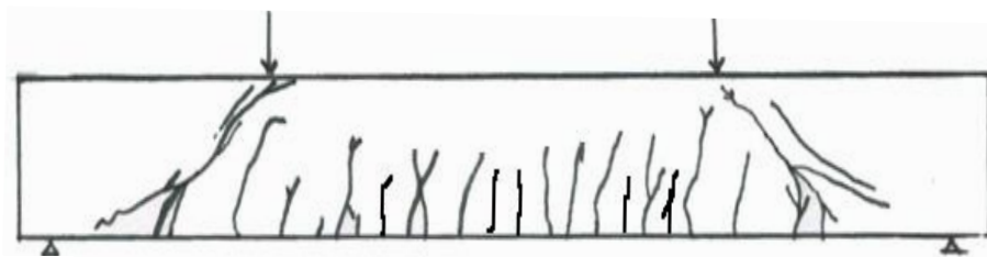
شکل ۱۵- الگوی ترک تیرهای BF (نمونه دوم)
