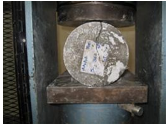
شکل ۱- طرز قرارگیری نمونه‌های استوانه‌ای در دستگاه آزمایش شکافت
