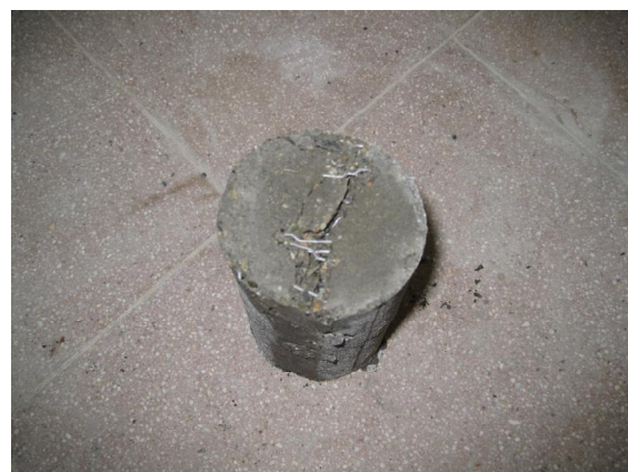
شکل ۵- نمونه استوانه‌ای حاوی الیاف فولادی پس از آزمایش شکافت
