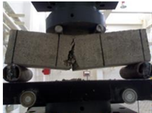
شکل ۲- طرز قرارگیری نمونه‌های منشوری در دستگاه آزمایش خمش
