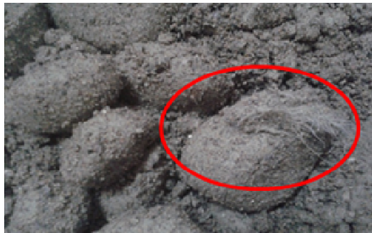
شکل ۱۱- نمونه‌ای از توپی شدن الیاف پلی پروپیلینی در داخل بتن گلتکی
