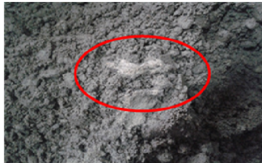
شکل ۱۱- نمونه‌ای از توپی شدن الیاف پلی پروپیلینی در داخل بتن گلتکی
