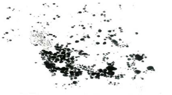
شکل ۳- تصاویر TEM از محلول نانو نقره (بزرگ‌نمایی ۱۰۰۰x)
