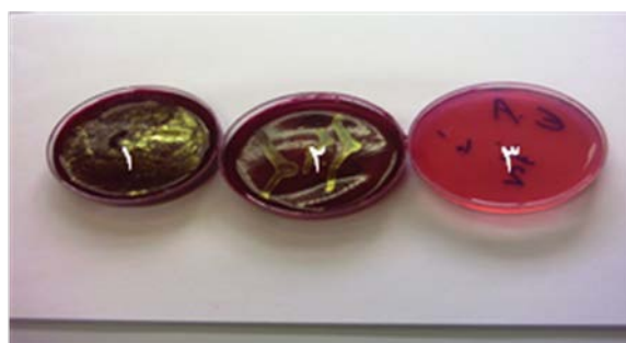
شکل ۸- مقایسه کشت میکروبی در غلظت 1 \times 10^5 cfu/ml: (۱) نمونه شاهد، (۲) کشت در تماس با پلیمر خالص، (۳) کشت در تماس با پلیمر حاوی نانو ذرات نقره
