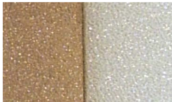
شکل ۱- تفاوت رنگ قبل و بعد از پوشش‌دهی با نانوذرات نقره
