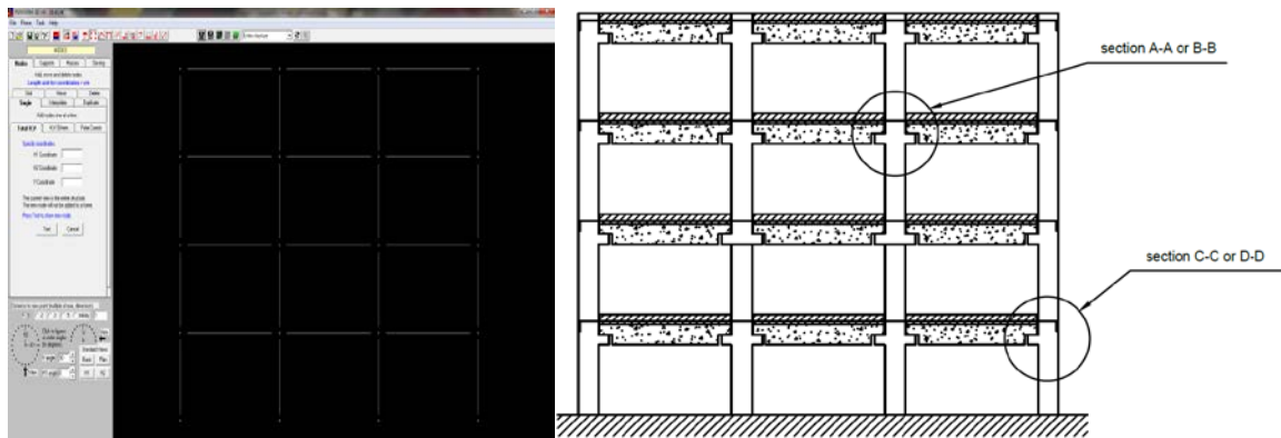
شکل ۸- نمای واقعی و ایده آل سازی شده در محیط نرم افزار از قاب خمشی پیش ساخته
