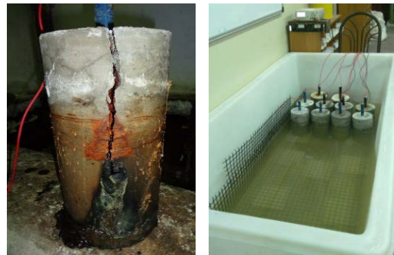
شکل ۱۰- آزمون حین و بعد از آزمایش خوردگی تسریع شده
