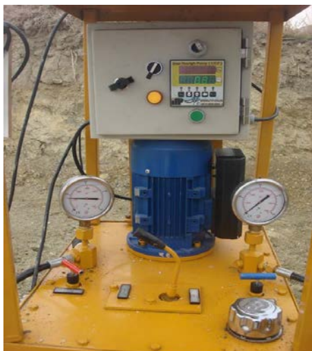
شکل ۱- شمای کلی از دستگاه جک کشش میخ
