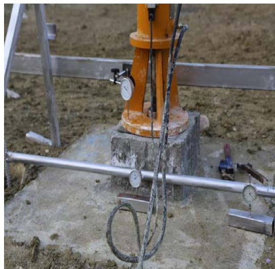
شکل ۲- تصویر تجهیزات جانبی جک کشش میخ و نحوه اتصال آن به میخ
