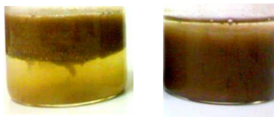
شکل ۵- مقایسه کاهش حجم لجن در آزمایش بهینه با نمونه شاهد
