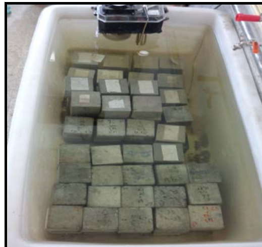
شکل ۱- نحوه قرارگیری نمونه‌ها در حوضچه آب
