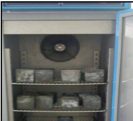
شکل ۲- نحوه قرارگیری نمونه‌ها در دستگاه انجماد و ذوب
