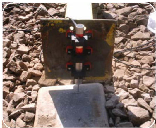
شکل ۱- تغییر مکان سنج در تست میدانی [۴، ۵]
