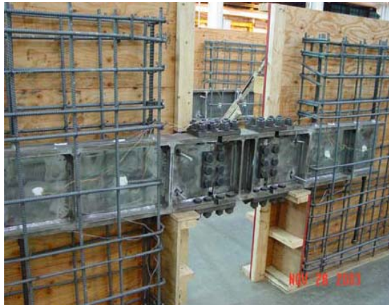
شکل ۶- تصویری از تیر مزدوج فیوز (FCB) [۲]
