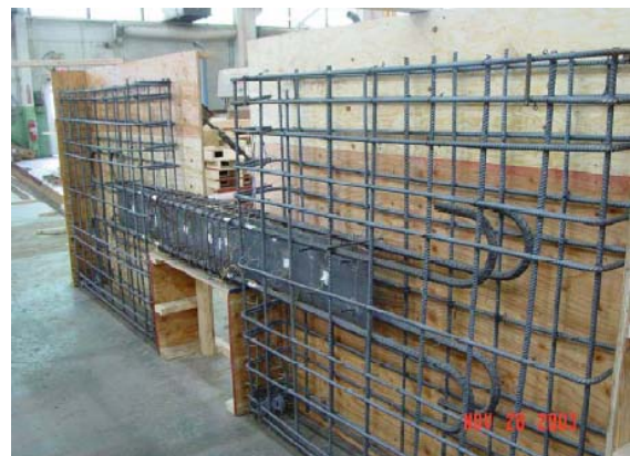
شکل ۵- تصویری از تیر مزدوج با ورق برشی جان (SPCB) [۲]
